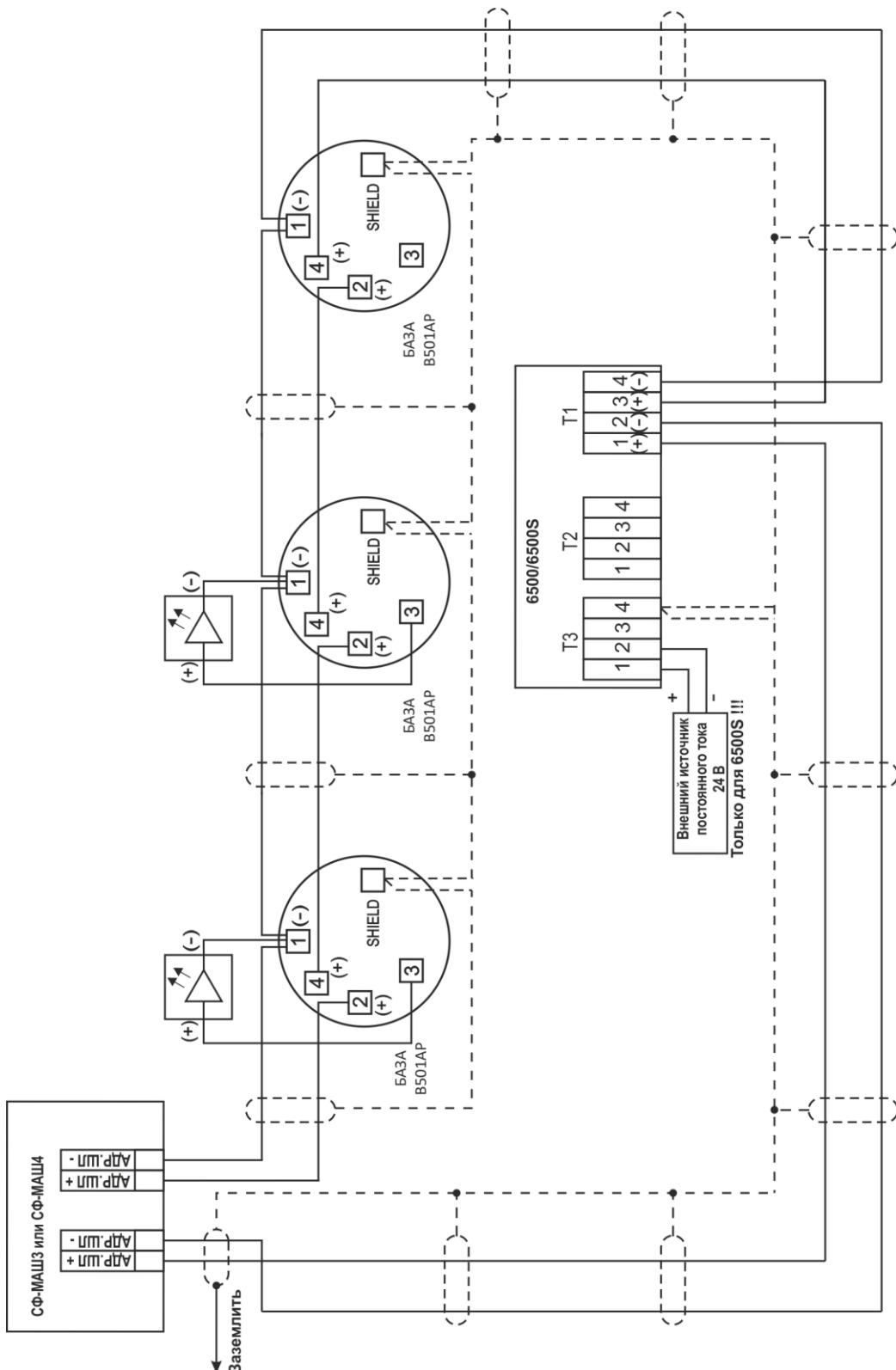
**Схема подключения адресных модулей контроля/управления в шлейфы «СФ-МАШ-3» и «СФ-МАШ-4».**
