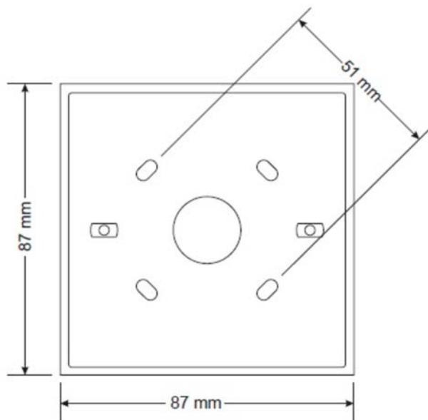
Рисунок 1. Размеры задней панели.
